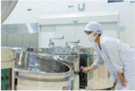
輻射熱が少なく快適な厨房環境を実現する電気モールドヒータ式回転釜
