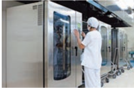
調理温度や時間管理もスイッチ操作ひとつでできるスチームコンベクションオープン
